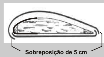
Esquema de entelagem de áreas parcialmente chapecadas
